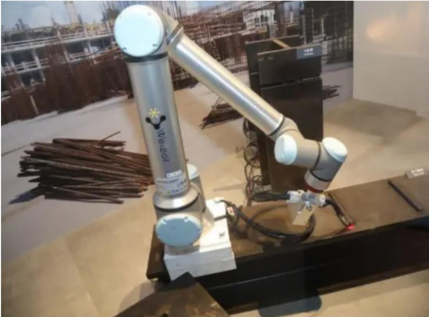
自動化燒焊需極高的精準度，因為鐵枝的外型不一，機械臂需先量度尺寸，然後再進行燒焊。
