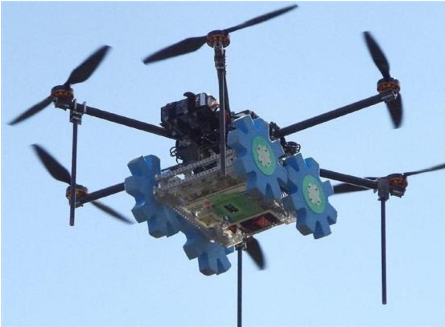
日本東北大學開發的飛行機器人，下方懸掛的小型機器人可送至火山口附近採集資料。圖擷自產經
