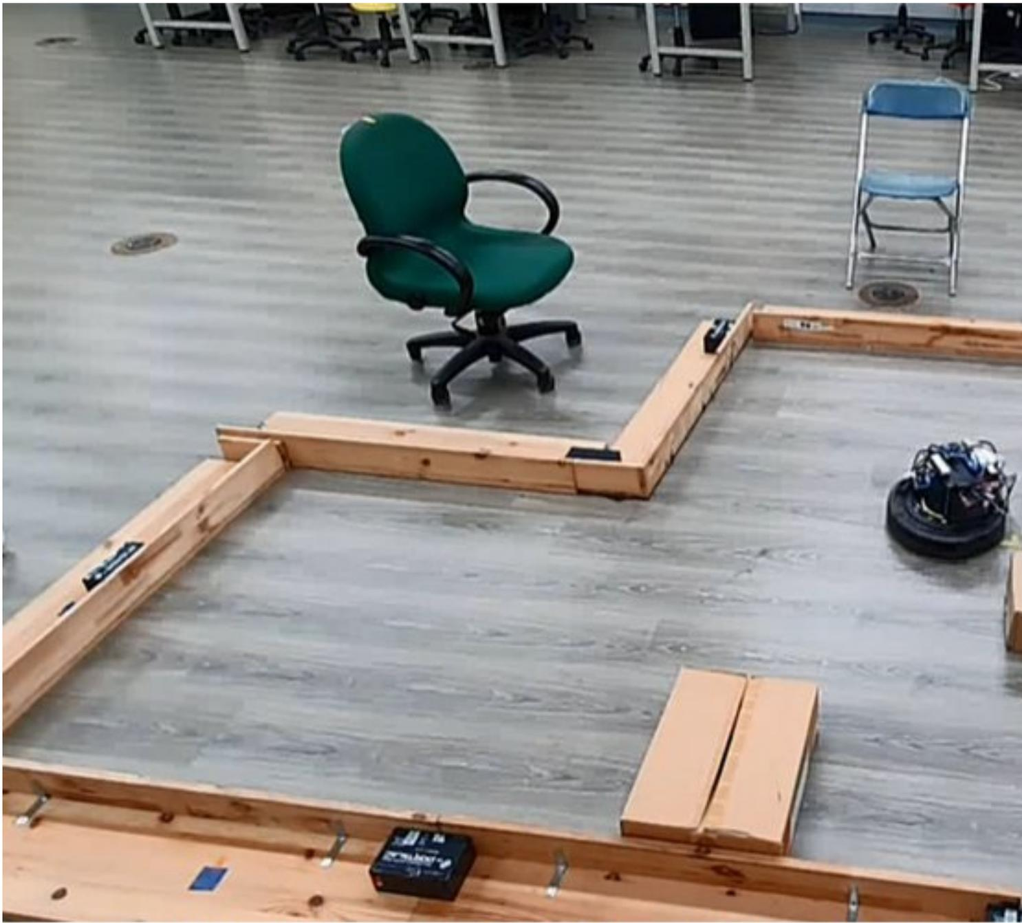
交大電機系教授宋開泰團隊研發的掃地機器人備有RealSense提供640×480像素且每秒30張的彩色影像和深度影像。遇到障礙物時，會調整角速度來閃避障礙物，並減慢線速度避免碰撞到障礙物。
