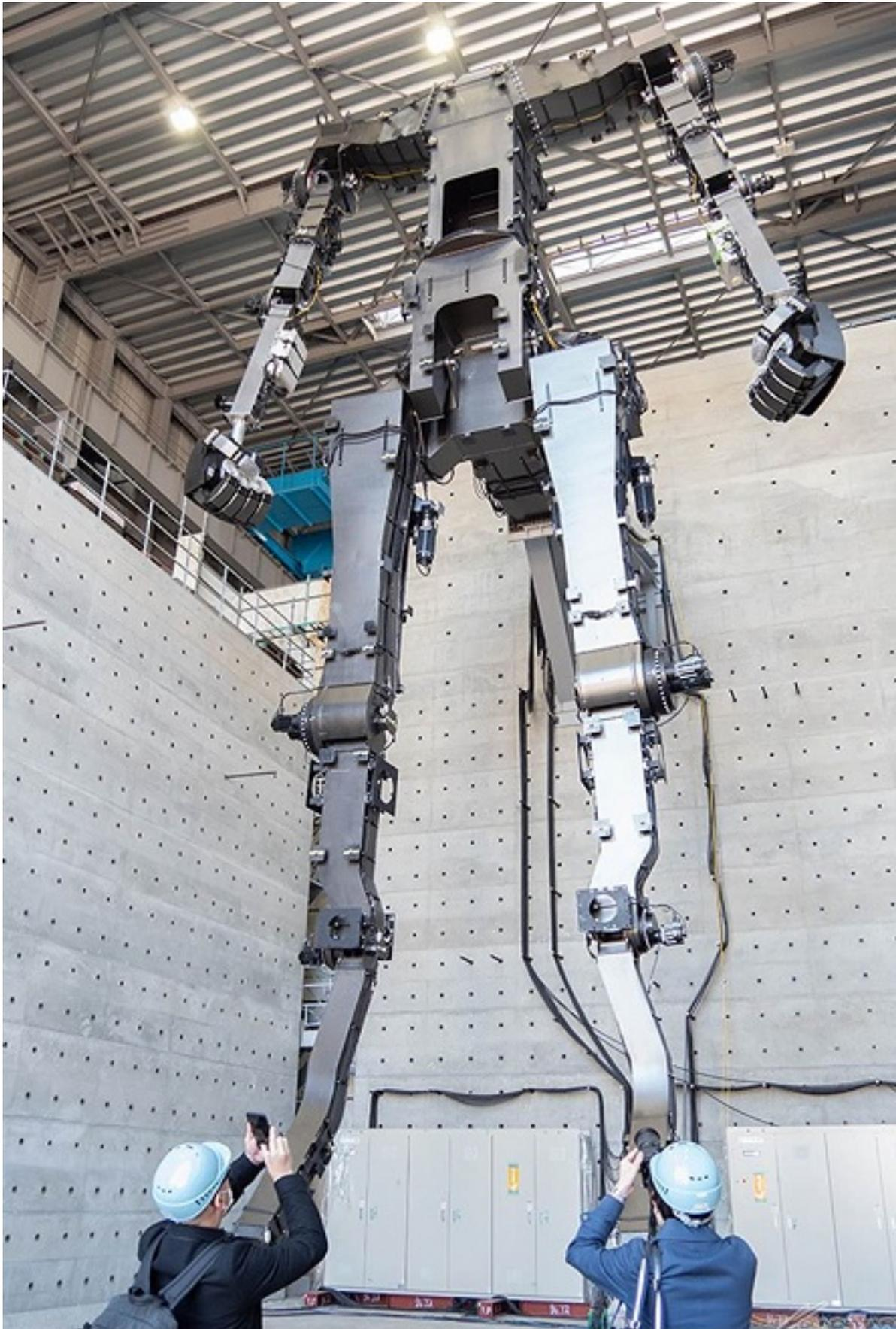
等比例鋼彈機器人的骨架。(圖/萬代)
